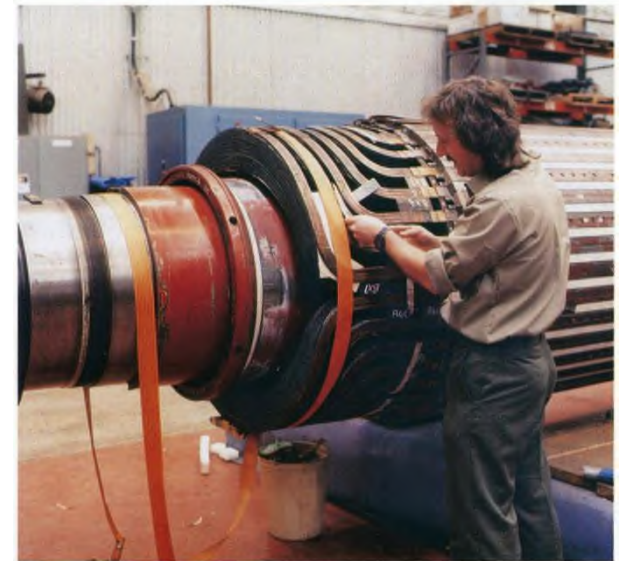
Δρομέας (rotor) μιας γεννήτριας 200 MW
